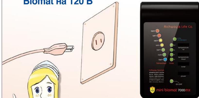
Экран контроллера показывает температуру устройства. В левой части экрана находится шкала по Фаренгейту. На экране также имеется выключатель питания и индикатор задержания электромагнитных волн. На правой стороне контроллера расположены выключатель питания, кнопки регулировки температуры и установки таймера. В случае какой-либо неисправности индикатор температуры 158°F / 70°C будет мигать красным цветом.
